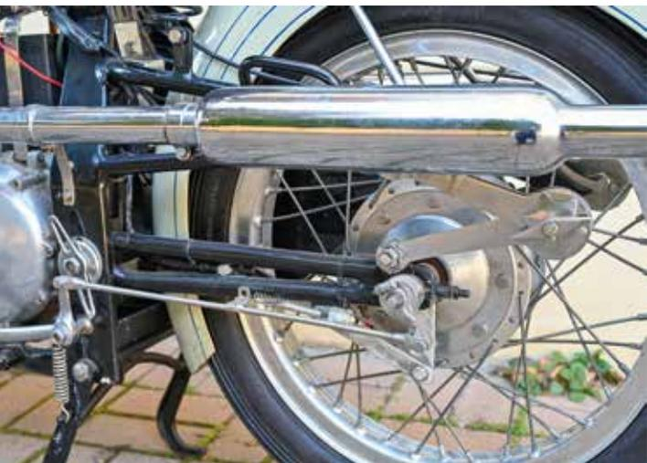
Le foto di questa pagina ci documentano il serbatoio da 12 litri di capacità, la sospensione posteriore a forcellone oscillante a doppio tubo con barra di torsione e ammortizzatori a compasso, la distribuzione completamente racchiusa e il telaio a doppia culla chiusa con la grossa coppa dell'olio alettata per la lubrificazione del motore.
