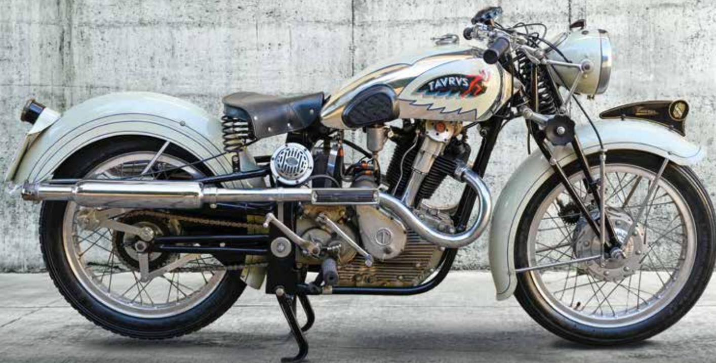
La linea ricercata e filante della Taurus G27 nella versione a telaio elastico del tipo a forcellone oscillante e barra di torsione. Il telaio elastico, ovvero con la sospensione posteriore, era disponibile con un sovrapprezzo di 700 lire rispetto alla versione con il telaio rigido.
